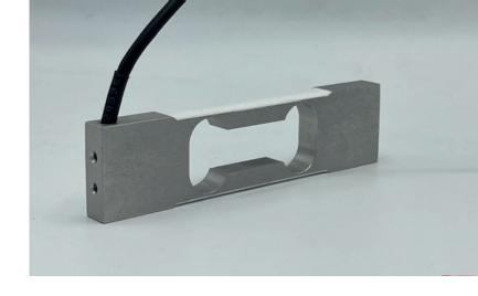
Cella di carico basso costo e basso profilo del tipo fuoricentro (off-center), per bilance o altre applicazioni industriali per piccoli pesi a singolo punto di misura con piattaforma massima di 200x200mm. Ideali per realizzazioni di contapezzi o misure di peso in laboratorio di analisi. Il rivestimento delle parti elettriche e dei sensori con silicone conferisce un grado di protezione contro polveri e liquidi di grado IP67.
