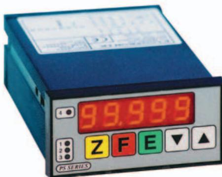
**L'indicatore per celle di carico PS30 è in grado di verificare se il peso della confezione rientra nella finestra programmata dall'operatore**
