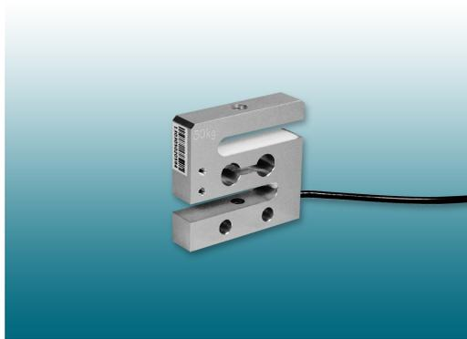
**DESCRIZIONE:** Cella di carico di tipo "S" in lega d'alluminio per applicazioni in trazione o compressione, particolarmente adatta per pesature di piccoli pesi in sospensione come sacche di liquidi per il settore medicale o prova di resistenza di trazione per tubi in plastica.
